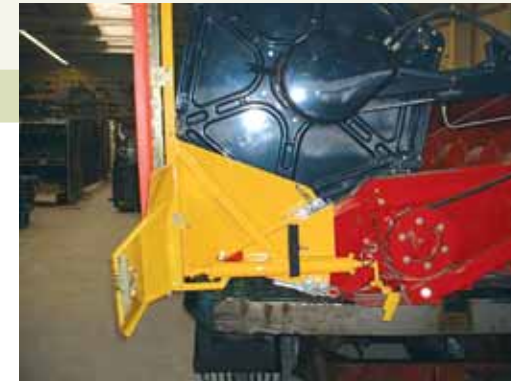
Scie à colza gauche Vue de l'entraînement mécanique
