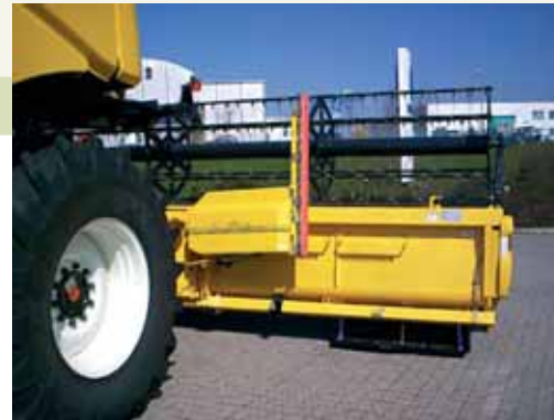
Scie en position de transport à l'arrière de la coupe
